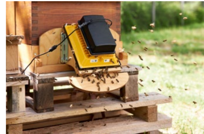
Buntes Treiben: Jede Biene wird im Eingangsbereich des Bienenstocks „gescannt“ und ihre Daten werden mithilfe der intelligenten Software erfasst
