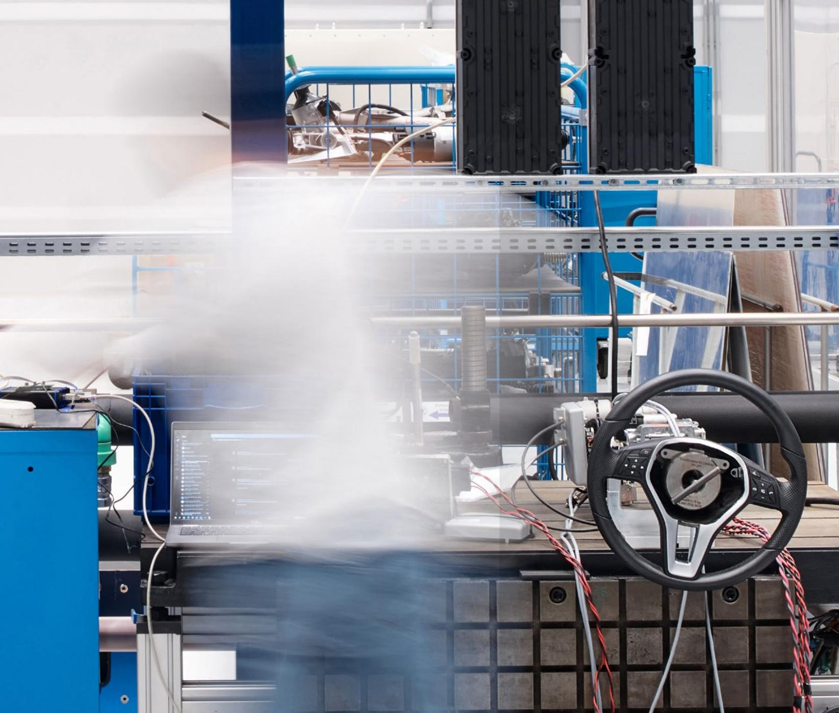
BEIM STEER-BY-WIRE-SYSTEM WIRD EIN LENKBEFEHL VIA SENSOR UND STEUERGERÄT AUSSCHLIEßLICH ELEKTRISCH WEITERGELEITET.
